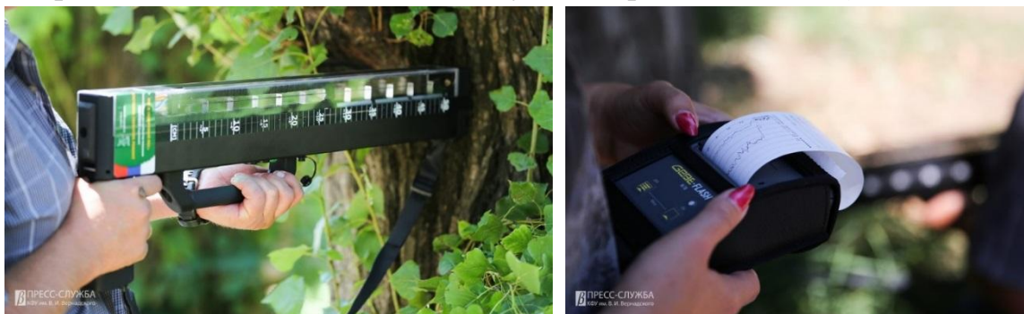
Рис. 4. Определение плотности древесины прибором RESISTOGRAPH® 6-я серия R650-SC
