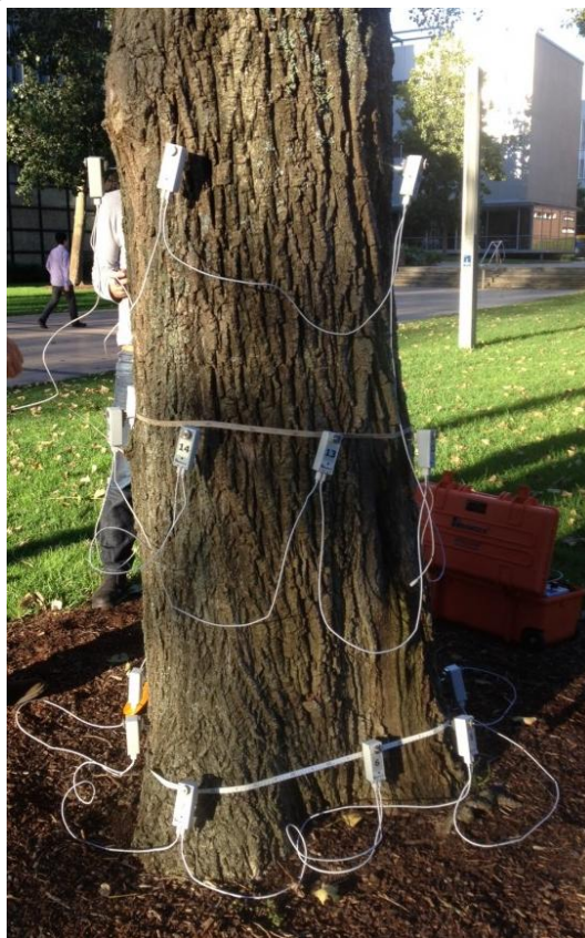
Рис. 1 Обследование состояния дерева с помощью ARBOTOM®
