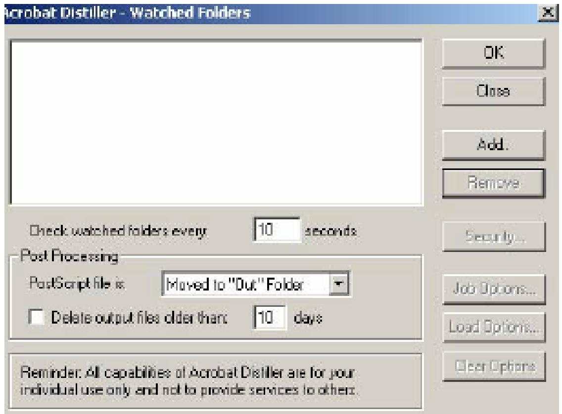
Здесь указываются Watched Folders и параметры обработки файлов для каждого из них. После того, как будет задана «папка» и выбраны параметры обработки файлов job options, в ней будут автоматически созданы две «папки» IN (для входящих .ps файлов) и OUT (для готовых \*.pdf файлов). После помещения в «папку» IN \*.ps файла Acrobat Distiller автоматически выполнит генерацию \*.pdf и переместит его в «папку» OUT.
