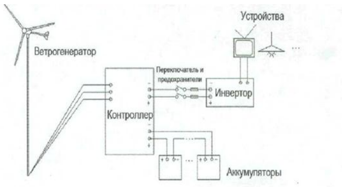
Рис. 3.5. Схема включения ветрогенератора к индивидуальному потребителю
