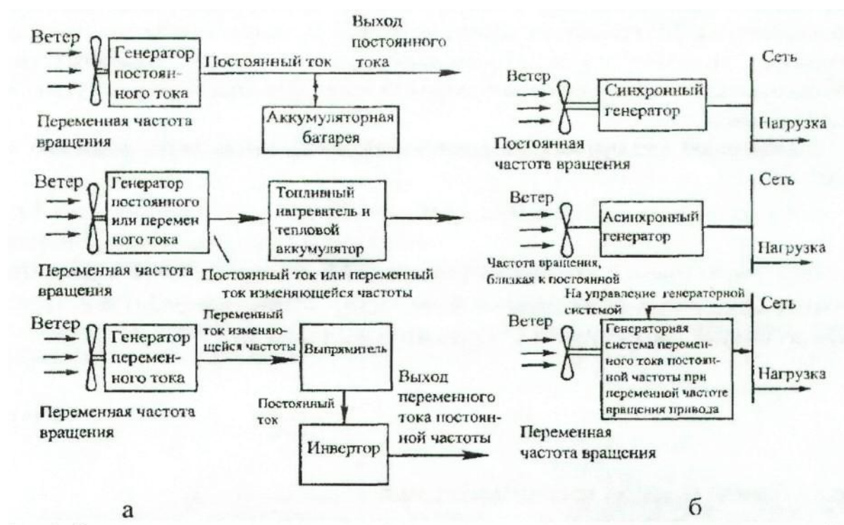
Рис. 3.8. Схемы генерирования и использования электроэнергии при автономной (а) и сетевой (б) работе ВЭУ.
