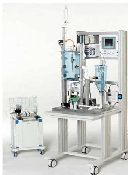
Система очистки сточных вод
