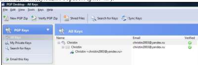
Рис. 4.9 - Генерированная пара PGP ключей
