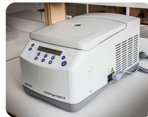
Центрифуга с охлаждением для выделения белков и нуклеиновых кислот
