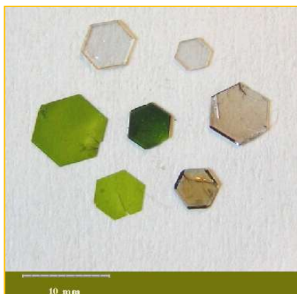
Кристаллы \text{Fe}_x\text{Ga}_{1-x}\text{BO}_3 с различным x
