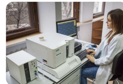
Мультиплексный анализатор биомаркёров Bioplex 200
