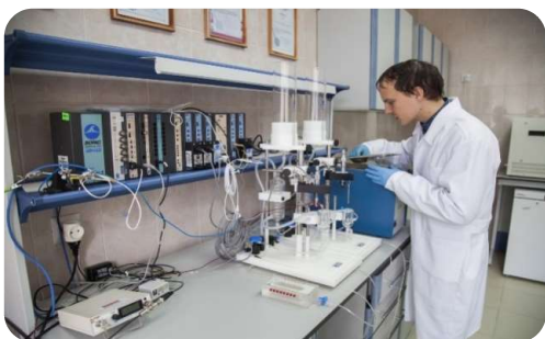
Полиграф MP-150 16-канальный для изучения изолированных органов
