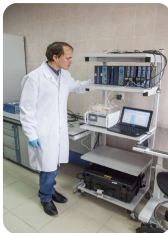
Аппарат для электрофизиологических исследований полиграф MP150W SW
