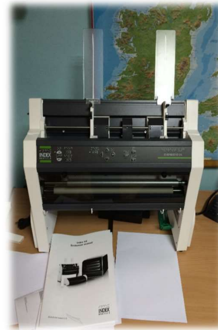
Принтер для печати шрифтом Брайля Romeo Attache Pro
