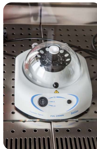
Vortex центрифуга для выделения нуклеиновых кислот
