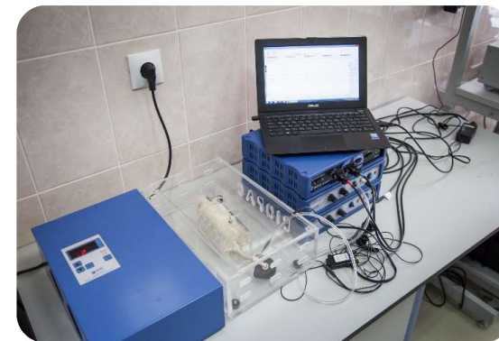
Полиграф 4-канальный MP-35 для физиологических исследований
