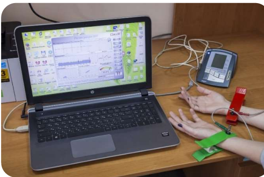
Аппаратно-программный комплекс «ОМЕГА-М» для оценки функционального состояния человека по вариабельности ритма сердца
