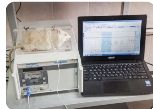
Ультразвуковой определитель кровотока с датчиками потока для сосудов
