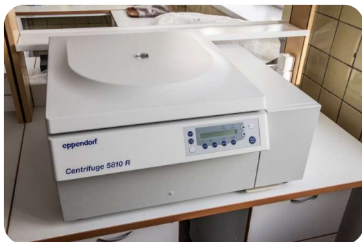
Центрифуга с охлаждением для центрифугирования больших объемов
