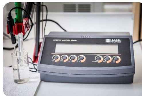
РН метр, позволяющий определять кислотность раствора
