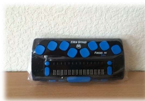
Ультра-портативный Дисплей Брайля Focus 14 blue с Bluetooth
