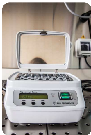
Твердотельный термостат для выделения нуклеиновых кислот
