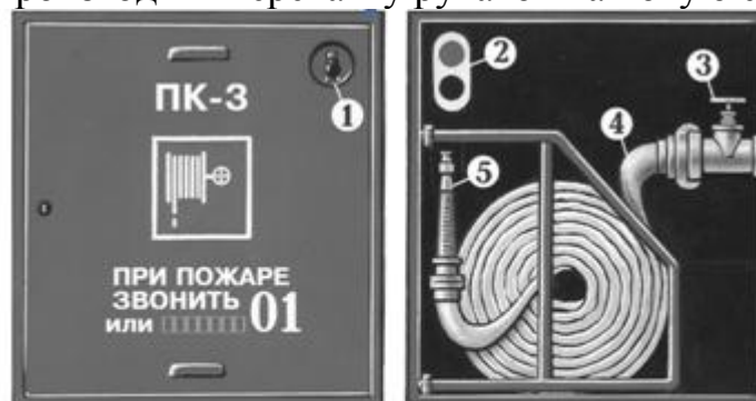
Внутренний пожарный кран:
