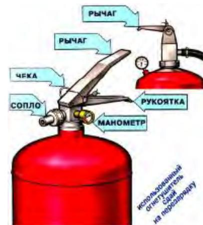
**ПРИНЦИП ДЕЙСТВИЯ.** Рабочий газ закачан непосредственно в корпус огнетушителя. При срабатывании запорно-пускового устройства порошок вытесняется газом по сифонной трубке в шланг и к стволу-насадке или в сопло. Порошок можно подавать порциями. Он попадает на горящее вещество и изолирует его от кислорода
