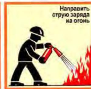
Ни в коем случае нельзя держать раструб углекислотного огнетушителя незащищенной, голой рукой – углекислотный снег имеет очень низкую температуру и это может стать причиной сильного обморожения рук.
