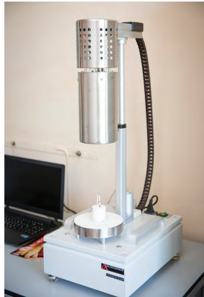
Установка для дифференциально-термического и термогравиметрического анализа Термоскан-2.
